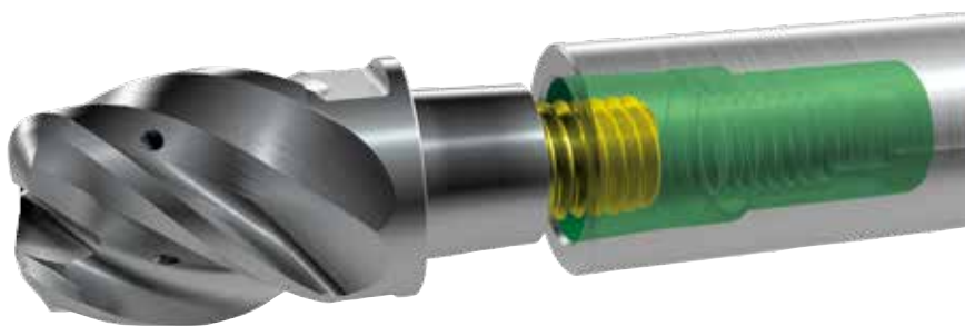
3 Концевая фреза iMX от Mitsubishi Materials состоит из хвостовика и режущей головки из твердого сплава. Стабильные конусные и торцевые поверхности придают инструментам жесткость, приближающуюся к жесткости монокристаллических твердосплавных фрез (фото: : MMC Hartmetall)
