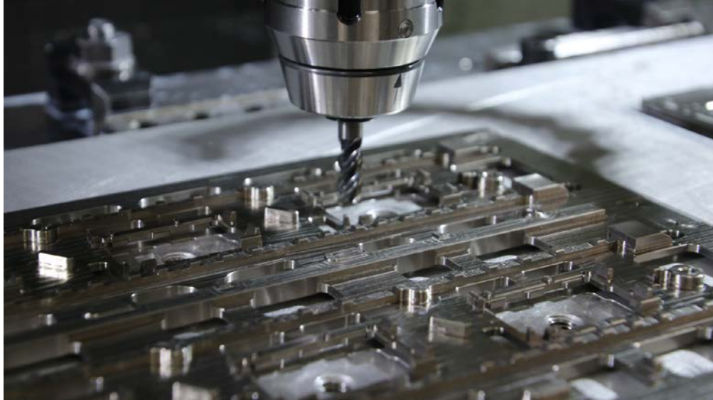
Proces obróbki: Wysoka dokładność i precyzja obróbki za pomocą frezów VQ produkcji Mitsubishi Materials
