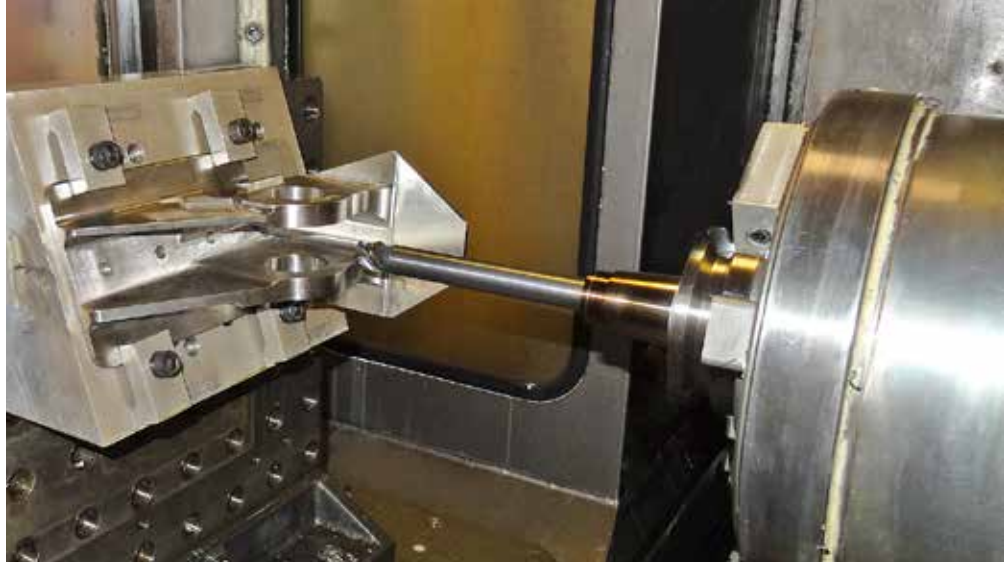
Lavorazione a forcella con frese iMX con testine intercambiabili Mitsubishi Materials
