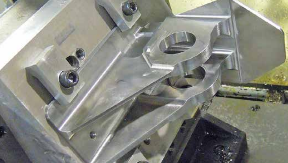
Forcella realizzata in TA6V (Ti-6Al-4V)
