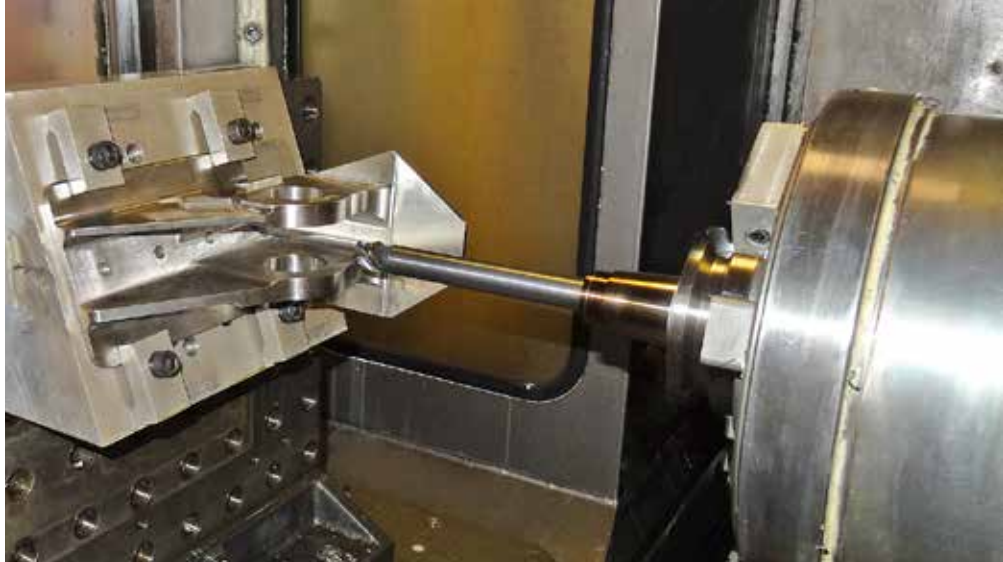
Obróbka wspornika za pomocą freza trzpieniowego typu iMX z wymiennymi głowiczkami produkcji Mitsubishi Materials
