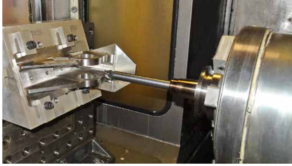
Mitsubishi Materials iMX değiştirilebilir başlıklı parmak frezeler tarafından işlenen bir destek parçası (brace)
