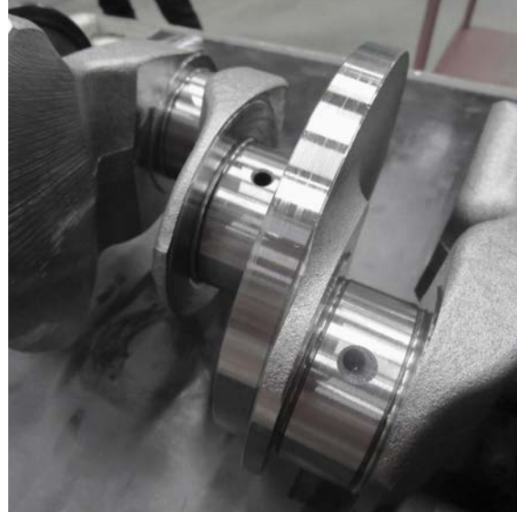
Agujero diagonal de \varnothing 5,00 mm y 100 mm de profundidad.
