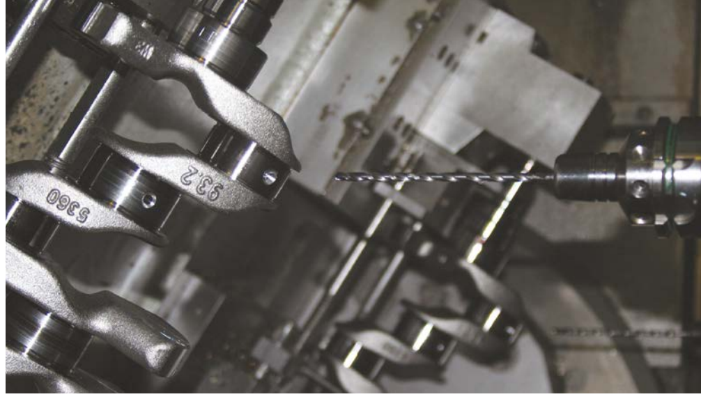
MPS1 - Çift millli Grob BZ530 tezgahında krank şaftı ana rulman yatağı derin açık pim deliğini delme.
