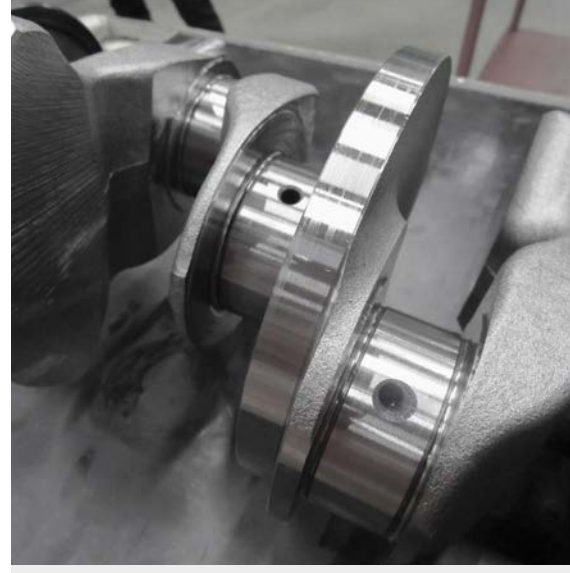
Çapraz delik Ø5,00 mm, 100 mm derinlik.
